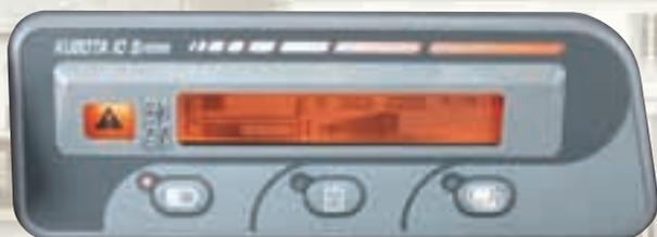
Информативна, интерактивно и функционально. Система контроля KUBOTA сообщает оператору всю важную информацию в удобной для восприятия форме: диагностические данные о текущем рабочем состоянии, технические предупреждения о скорости двигателя, счетчик времени, а также данные об уровне топлива, температуре и уровне масла. Она даже сообщает, когда бак наполнен во время заправки. В итоге уменьшается время простоя и затраты на ремонт.
